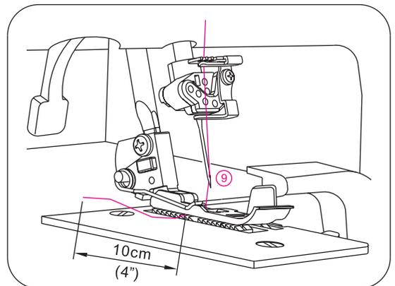
(2) Enfilage de l'aiguille chaînette ou centrale pour le point de recouvrement (bleu)
