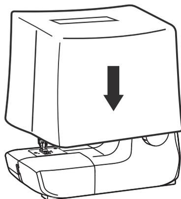
En cas de non-utilisation de la machine à coudre, débranchez toujours la fiche de raccordement au secteur. Veuillez utiliser la housse anti-poussière (s). Conservez la machine à coudre dans un endroit sec, hors de la portée des enfants. Si la machine à coudre ne doit pas être utilisée pendant une longue période, il faut la protéger de la poussière, de la saleté ou de l'humidité.
