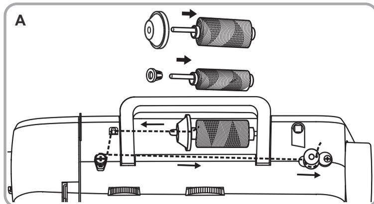
A. Placez la bobine (m) sur le porte-bobine (15) et fixez avec l'arrêt pour bobine (r).
