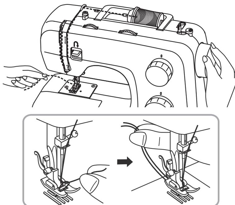
Tenez le fil supérieur avec votre main gauche. Tournez la roue à main (21) dans le sens contraire des aiguilles d'une montre jusqu'à ce que l'aiguille soit complètement remontée (un tour complet).
