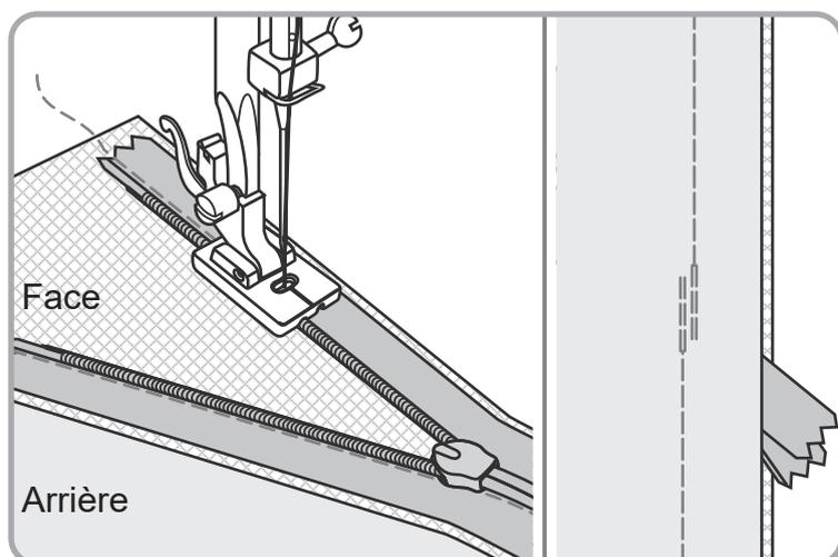
Pour fixer l'autre moitié de la fermeture, épinglez à l'envers de manière à ce que les dents soient sur la ligne de couture (1.6 cm) et à 1.9 cm du rebord supérieur du tissu, tel que décrit ci-dessus. Assurez-vous que la fermeture ne soit pas tortillée vers le bas. Utilisez le renforcement gauche du pied en vous assurant que le marquage central soit toujours aligné avec l'aiguille et le point, tel que décrit ci-dessus.
