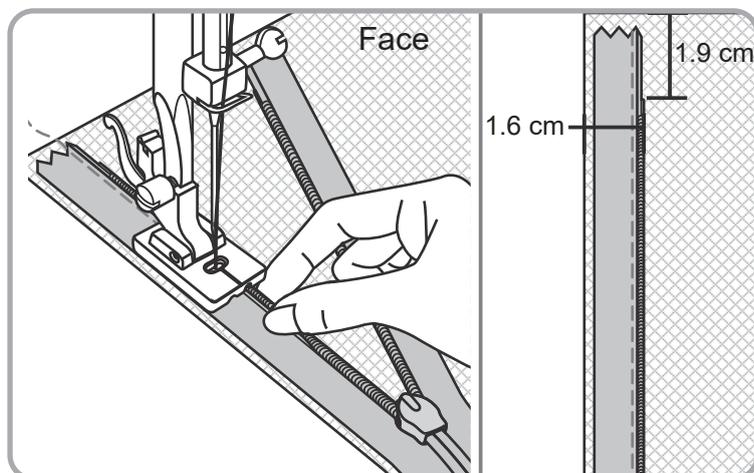
Le pied pour fermeture à glissière invisible permet de coudre des fermetures invisibles sur des jupes, des robes et sur une multitude de vêtements et accessoires.
